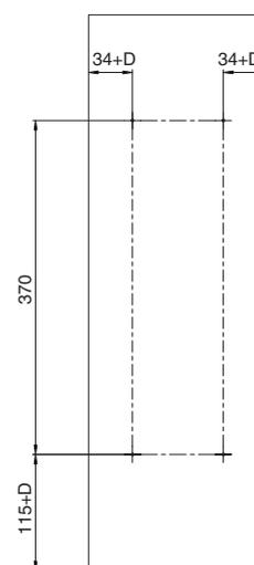
D – размер наложения фасада на боковую стенку каркаса
