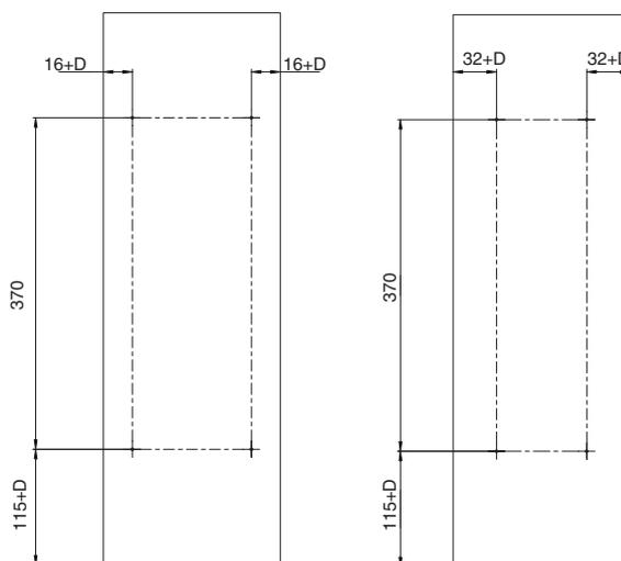
D – размер наложения фасада на боковую стенку каркаса
